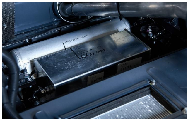
実証実験車両に搭載されている CO 2 回収装置
