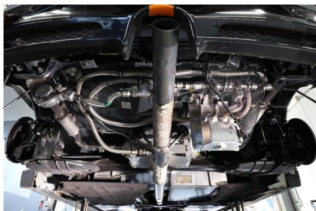
実証実験車両に搭載されている CO<sub>2</sub> 回収装置
