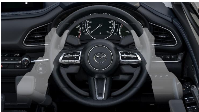
リング式アクセル(直感コントロール機能付き)
