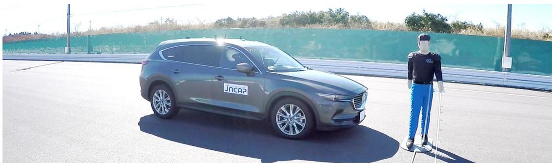
歩行者対応被害軽減ブレーキ試験の様子(写真提供:NASVA)
